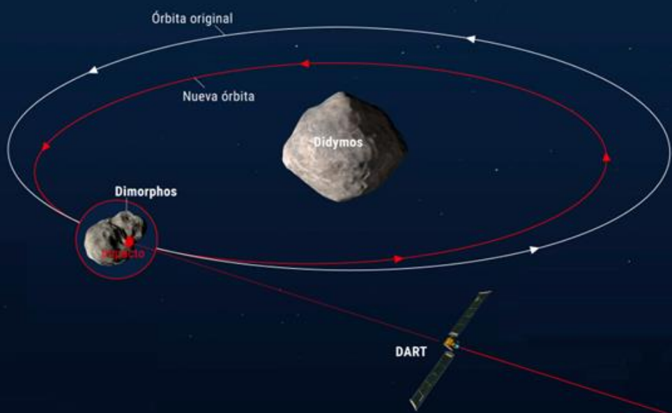
Esquema de modificación de la órbita del asteroide Dimorphos tras el impacto de la misión DART
